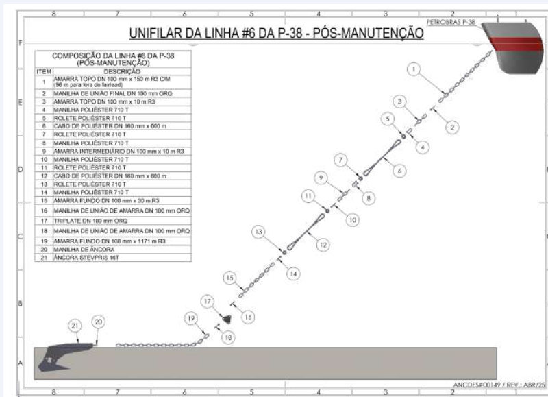
Figura 7: Exemplo de um diagrama de configuração de linha de ancoragem da plataforma P-38.
